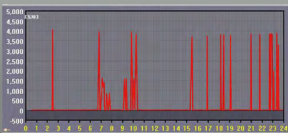
電熱水器未啟動定時器（耗電 6.91 度）
