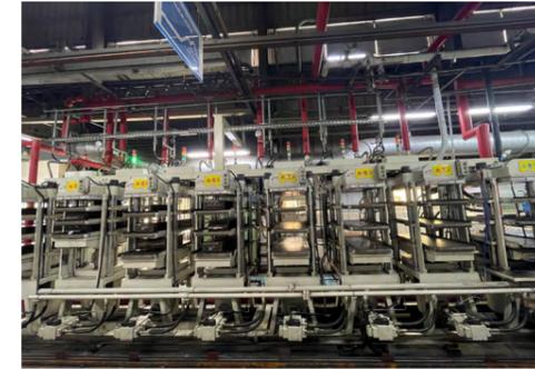
碳纖加熱能源轉換 - 電熱設備改為蒸氣式系統
